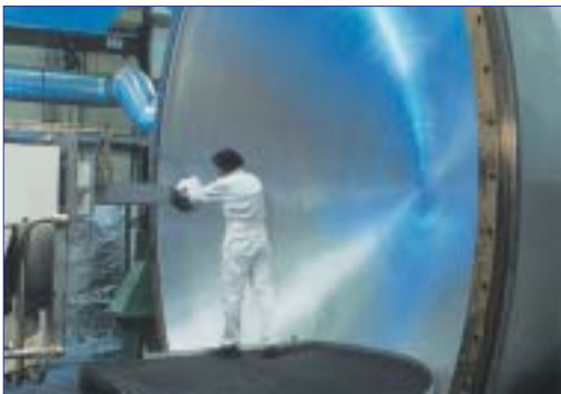
Spinforming für den Cryo-Tankdom der Ariane 5
