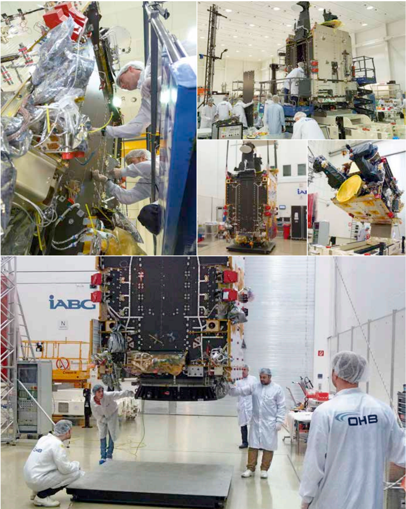
Hispasat AG1 am Ende der Integrationsphase im Reinraum der OHB System AG in Bremen (oben) sowie zu Beginn der Umwelttestkampagne im Raumfahrtzentrum der Firma IABG in Ottobrunn (untere Bilder).
